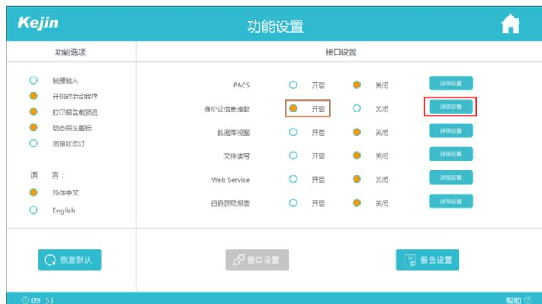
(5) 进入详细设置界面，对端口号进行设置，点击“确定”按钮，完成身份证读取接口的设置。
