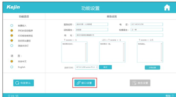
(3) 在接口设置界面, 点击“文件读写”的“开启”按钮后, 文件接口开启成功; 再点击对应的“详细设置”按钮;
